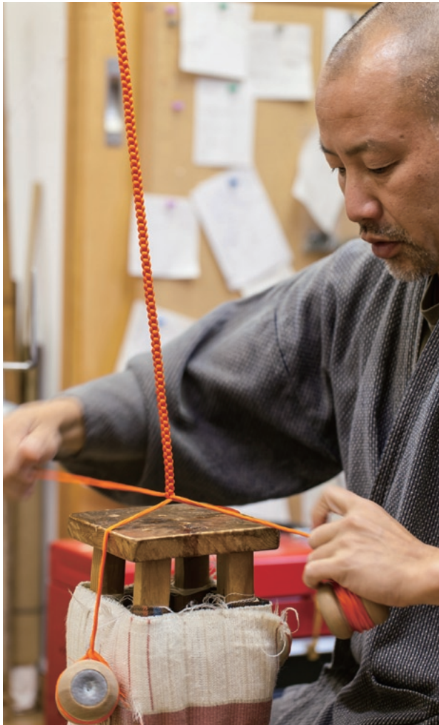
遠心力を利用しながらの「組み」工程。結びをつくったり、房をつけたり処理を施して仕上げる。この帯締で1本16,800円。
