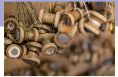
組み玉の重さは匁で量られており、四つ打ちの帯締であれば1つ120匁の玉が用いられる。
