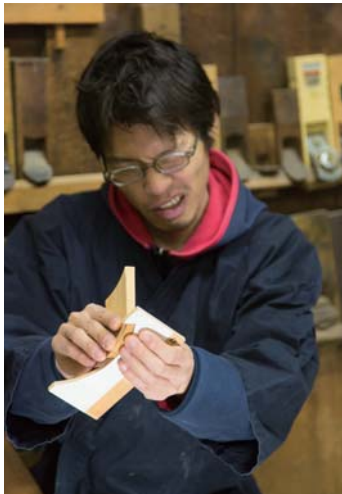
「正直」に当てながら、角度を確認。鉋の奥には蛍光灯を置き、光の漏れ具合を確認する。
