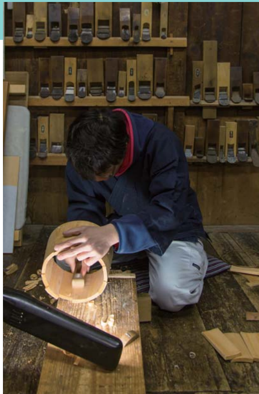
100丁もの鉋が並ぶ工房での作業。1つの桶に使う鉋は7~8種だが、桶のサイズが違えば使う鉋もまた異なる。
