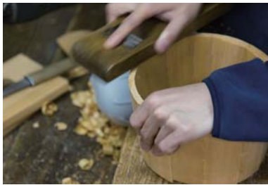
口の部分を水平に削る。片方が削れると、これを基準に反対側の口を水平に削る。
