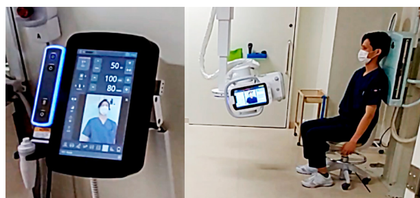
Fig.1 操作卓の表示モニター（画像左）、X線管保持器の表示モニター（画像右）
