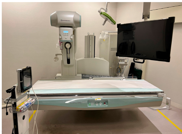
Fig.1 島津製作所社製X線テレビシステムSONIALVISION G4 LX edition
