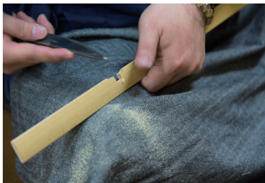
仕上げの作業。引っ掛ける部分は、盃を逆さにした形に開けられる。これもひとつずつ手作業。
