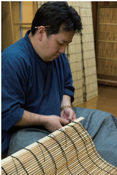
編み上がったすだれの上下に竹を取り付ける。息子さんと2人で分業している。
