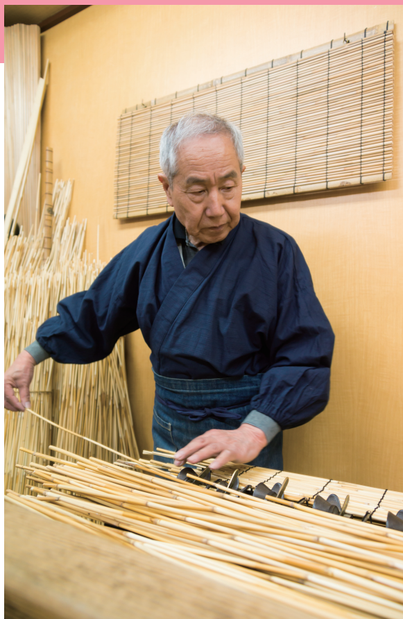
葎の歪みを調節しながら編み機にセット。葎の硬い部分が端にくるようにそろえて編むことで丈夫に仕上がる。
