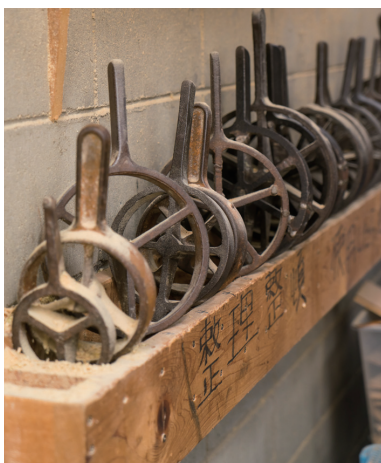
一本の竹を割る道具は菊割と呼ばれる鋳物を使用。3等分、5等分など割りたい数に合わせて使い分けている。
