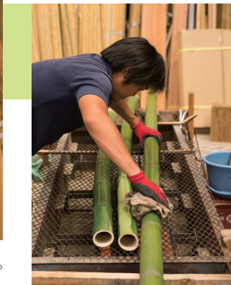
火炙りの作業は熱さとの戦い。根気よく、ていねいに油をふき取っていく。
