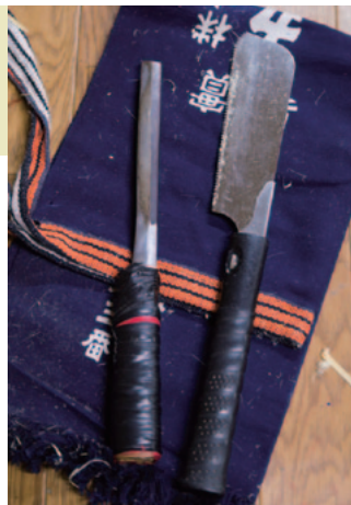
おもな道具は型と鉋。他の伝統工芸と違い京提灯づくりは今でも手に入る道具を使用している。
