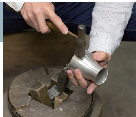
石目とよばれる肌に仕上げる工程。口をつける部分、くぼんだ腰部分、下の部分など箇所によって金鍬を使い分ける。
