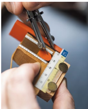
印材を挟んで中心をとり、印面を傷つけずにグリッドが引ける自作の治具。
