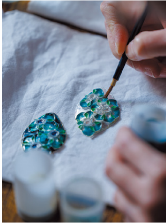
全体に同量の釉薬が載るように筆を運ぶ。箇所によって差があると焼きムラになってしまう。
