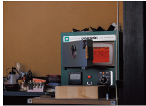
電気炉。七宝は陶器と違い焼き時間が短いため、窓から覗いて焼き具合を見張る必要がある。
